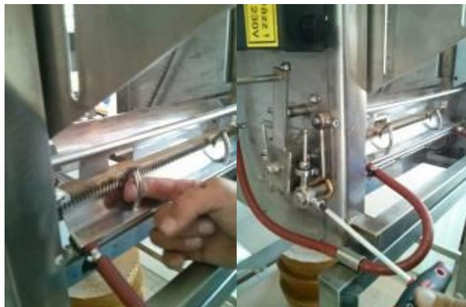
Die zur Seitwärtsbefestigung der Rähmchen dienenden Schrauben befinden sich unterhalb und oberhalb des Rähmcheneinzugschalters (auf dem Bild mit Pfeil markiert). Mit der Lösung der Schrauben verstärken wir den Seitwärtsdruck der Rähmchen, mit dem Anziehen der Schrauben verringern wir den Seitwärtsdruck der Rähmchen. (Rähmchen bewegen sich leichter)
