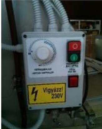
Mit der grünen Magnetschaltertaste an der Schalterbox an der Maschine setzen Sie die Deckelmaschine in Stand-By-Status. Bei einem eventuellen Stromausfall verhindert der Magnetschalter den unbeabsichtigten Neustart der Maschine.
