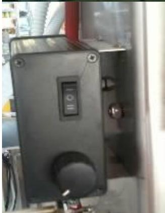
Weitere Schalter befinden sich auf der rechten Seite, wenn man gegenüber der automatischen Deckelmaschine steht. Mit dem Schwingungsschalter kann die Seitwärtsbewegung der Messer, deren Geschwindigkeit nicht regelbar ist, gestartet werden.
