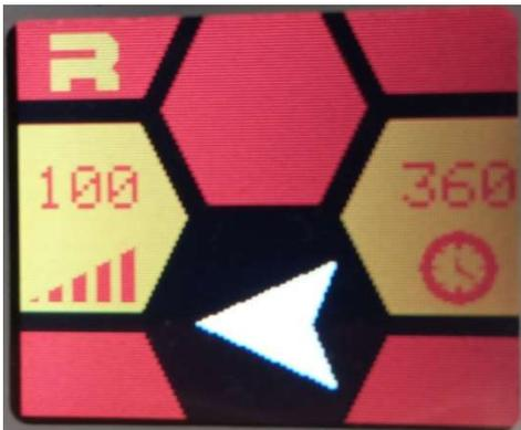
PROGRAM-Taste wieder gedrückt wird, kann die Laufzeit in die anderen Drehrichtung gewählt werden. Die Endgeschwindigkeit kann mit dem Drehknopf eingestellt werden. Während des Schleuderprozesses kann die Geschwindigkeit nicht verändert werden. Das Display zeigt die eingestellte Geschwindigkeit auf der linken Seite.
