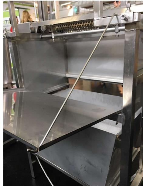
Danach ist das Tropfentablett zu montieren. Setzen Sie die rechtwinkelten Enden der Haltermetallstäbe in die zwei Löcher auf dem oberen Teil des Tablett, danach hängen Sie die anderen Enden der Stäbe auf das Gestell, das die Rahmen hält. Die zwei Henkel auf dem unteren Teil des Tablett müssen sich auf das Gestell stützen.
