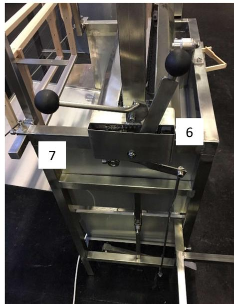
Bei Bedarf kann der Abstand zwischen den Messern mithilfe vom Pedal (9.) oder vom Hebel (6.) breiter oder enger gestellt werden. Das Sperrung oder Entsperrung des Hebels kann mit dem fixierenden Hebel durchgeführt werden. (7.)
