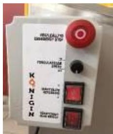
Schalten Sie den an dem Stecker befindlichen Hauptschalter, und damit den Strom für die Maschine ein. Es ist wichtig, den Status der roten NOT-HALT-Taste zu überprüfen, damit sie nicht gedrückt ist. In diesem Fall ziehen Sie die NOT-HALT-Taste aus, oder drehen Sie sie ab, womit Sie den NOT-HALT-Status ausschalten.
