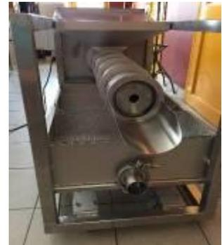
Füllen Sie das frisch gedeckelte Wachs durch die Füllöffnung in die Maschine. Im Laufe des Pressens werden das Wachs und der Honig getrennt. Am Ende der Schnecke erscheint die „Wachsrolle“ und der im Zuge des Verfahrens gewonnene Honig fließt in die unterhalb der Schnecke befindliche Tropfschale. Der unterhalb des Schneckenendes, in der auf dem Honig sammelnden Tablett gestellten Siebschale gesammelte, mit Wachs gemischte, ausgepresste Honig ist wieder in die Pressemaschine zu füllen.
